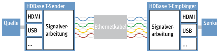
Bild 1. Blockdiagramm einer HDBaseT Übertragung Quelle: die Autoren
